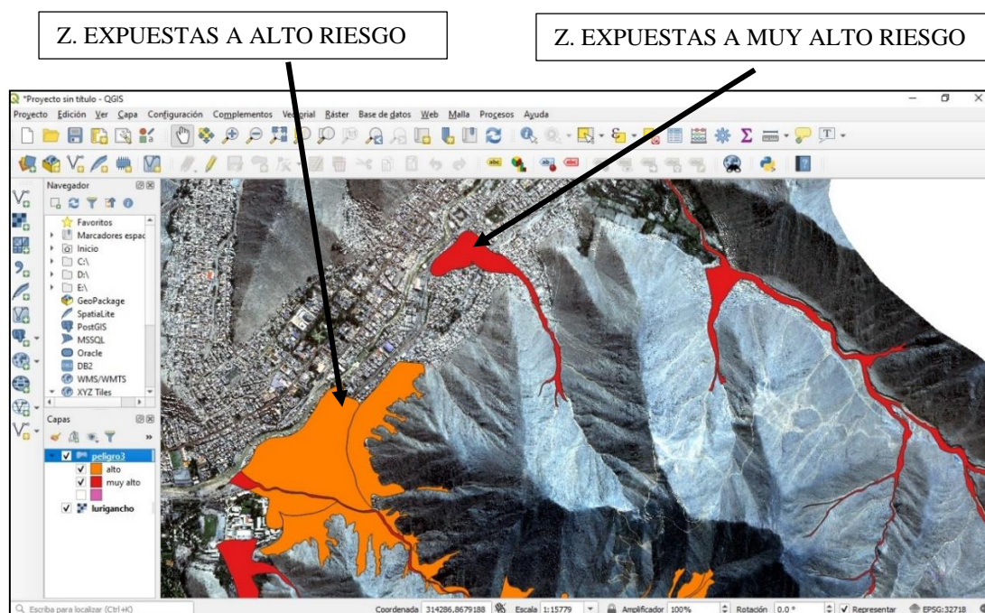
Figura 31. Integración en QGIS de información geológica con imagen satelital de PerúSAT-1 determinando las zonas expuestas a un alto (naranja) y muy alto (rojo) riesgo.
