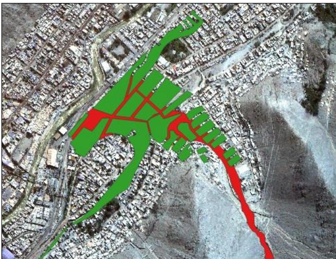
Figura 34: Identificación de zonas vulnerables con probabilidad muy alta que se encuentran expuestas a peligro en la zona de la Cooperativa Pablo Patrón y Mariscal Castilla - Distrito de Lurigancho-Chosica.
